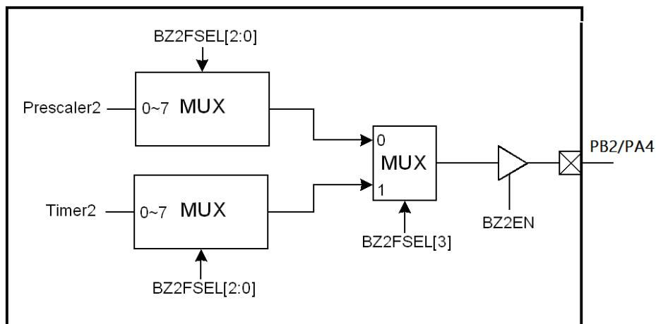
图 23 蜂鸣器 2 结构框图
