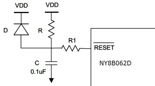
图 39 外部上电复位硬件连接图
