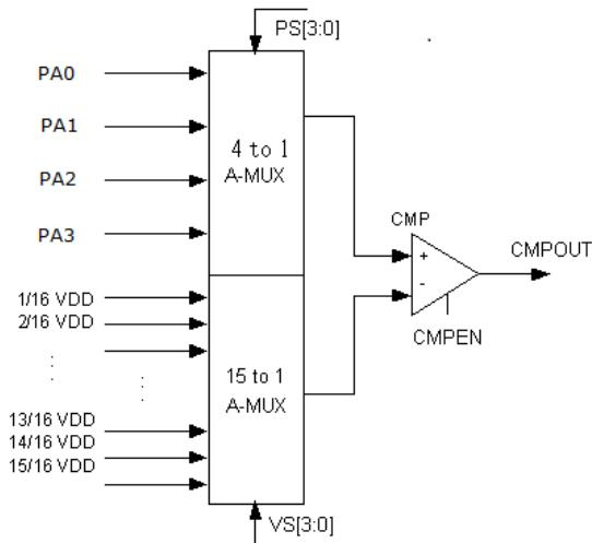
图 32 比较器P2V模式结构框图
