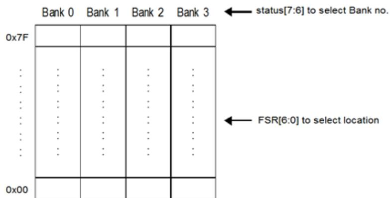
图3 间接寻址方式存取数据存储器
