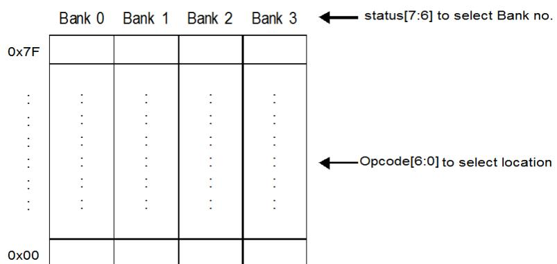
图4 直接寻址方式存取数据存储器
