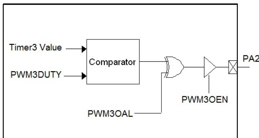
图 26 PWM3 结构框图
