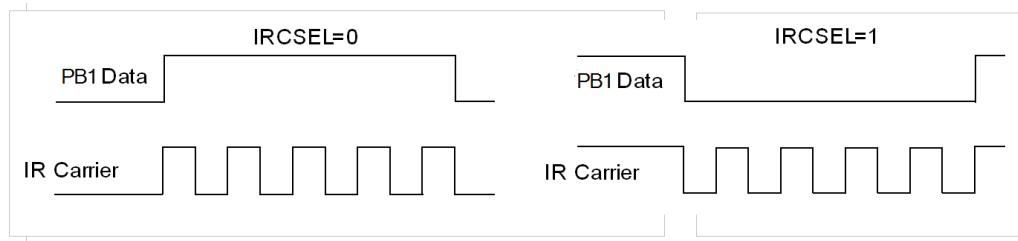
图 30 红外线载波的极性 vs. PB1 数据
