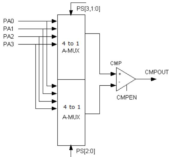
图 33 比较器P2P模式结构框图
