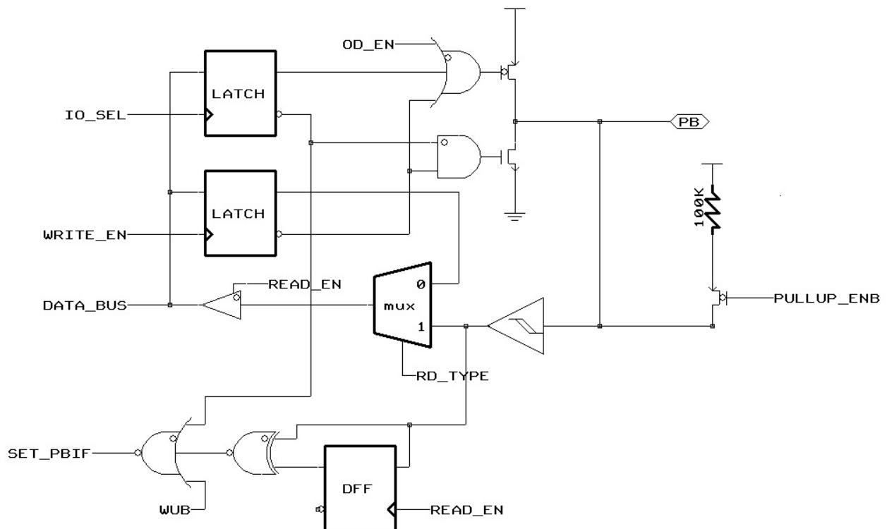
图 14 PB4, 5 引脚结构框图
