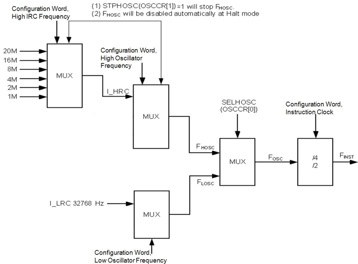
图 35 NY8B061E 振荡配置结构图
