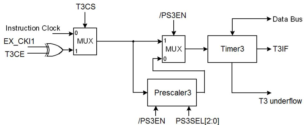
图 24 定时器 3 结构框图
