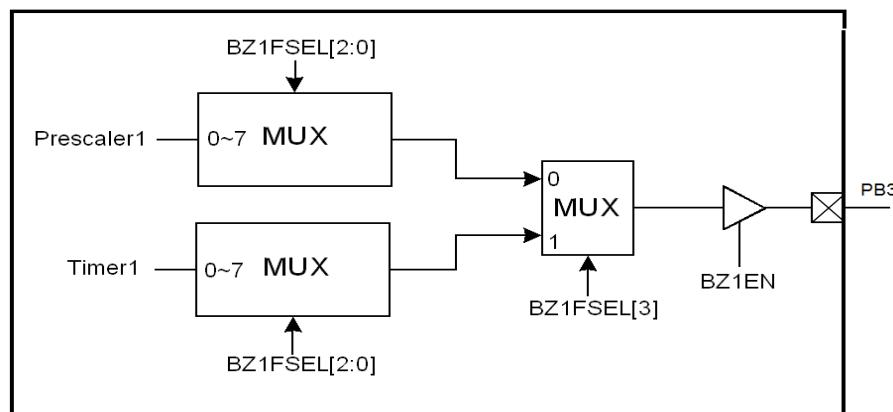
图 19 蜂鸣器 1 结构框图
