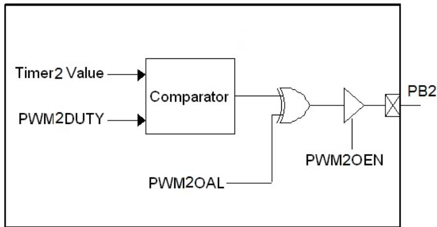
图 22 PWM2 结构框图
