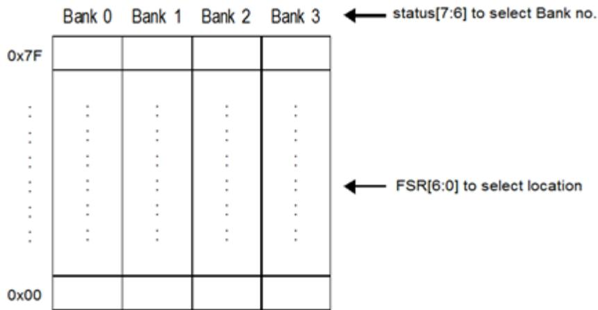
图 3 间接寻址方式存取数据存储器
