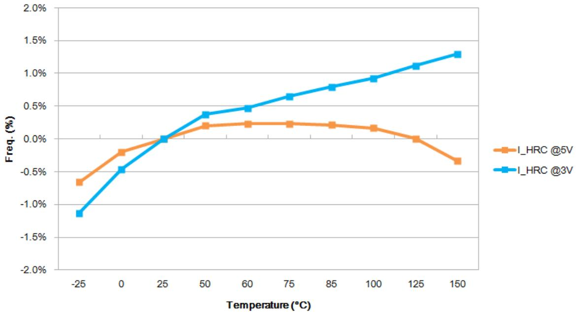
6.6.3 低速 RC 振荡频率与电源电压曲线图
