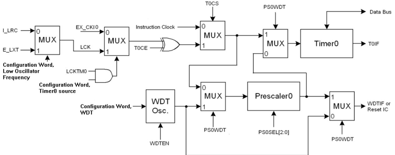
图 15 定时器 0 与 WDT 结构框图
