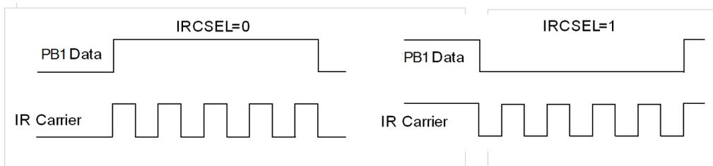
图 29 红外线载波的极性 vs. PB1 数据
