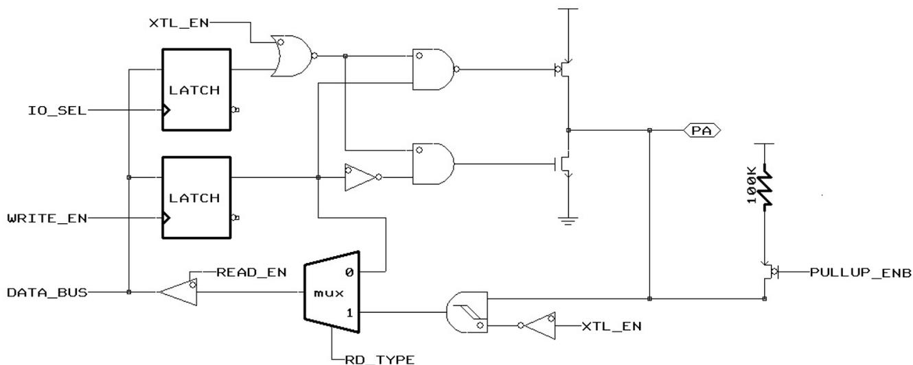
图 9 PA6, PA7 引脚结构框图
