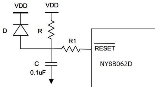
图 38 外部上电复位硬件连接图
