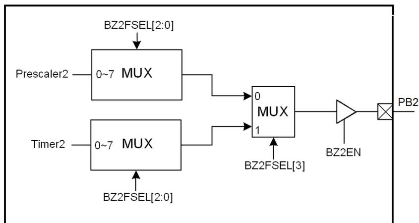
图 23 蜂鸣器 2 结构框图
