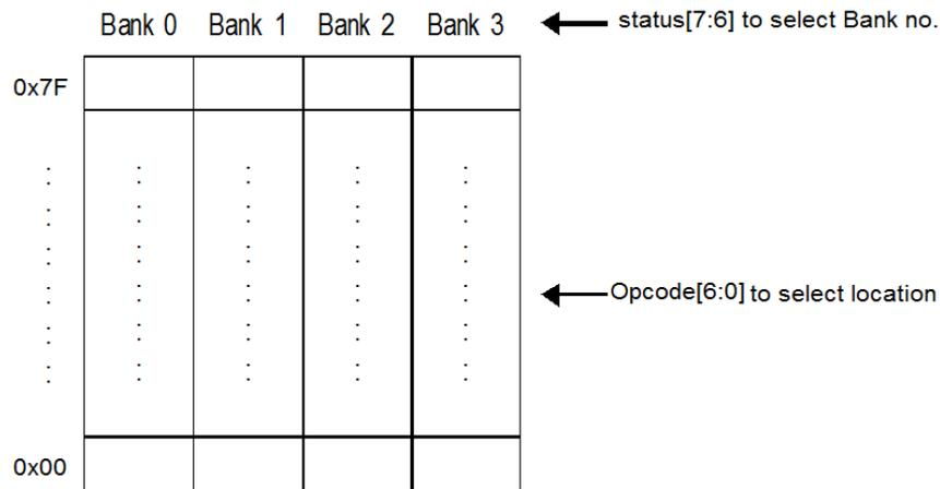
图 4 直接寻址方式存取数据存储器
