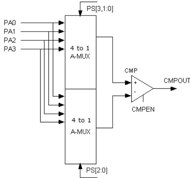
图 32 比较器P2P模式结构框图
