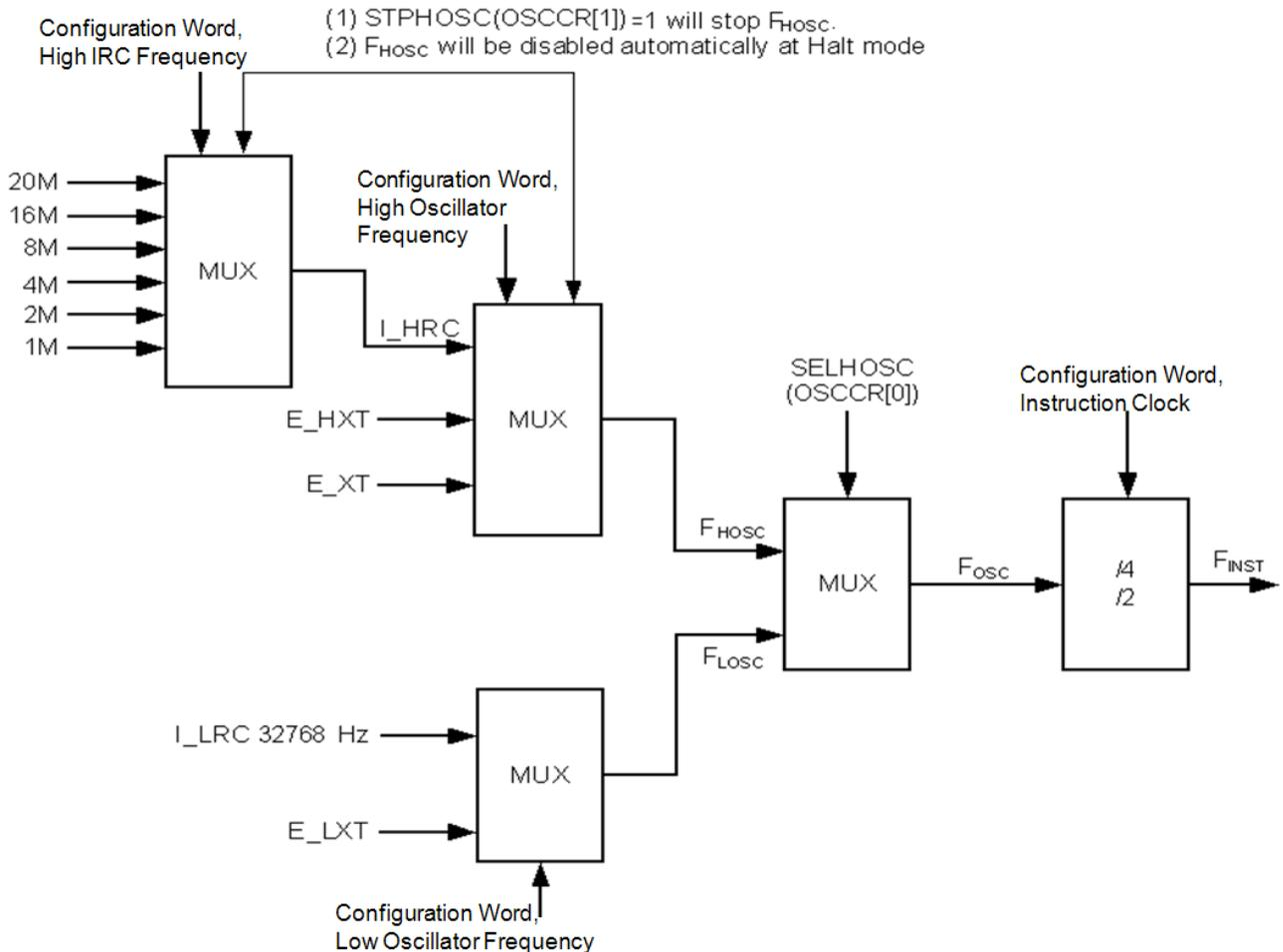
图 34 NY8B062D 振荡配置结构图
