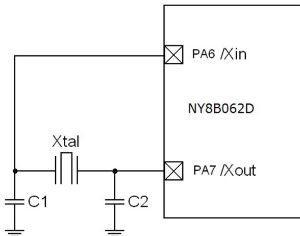
图 35 外部晶体振荡器的硬件连接图
