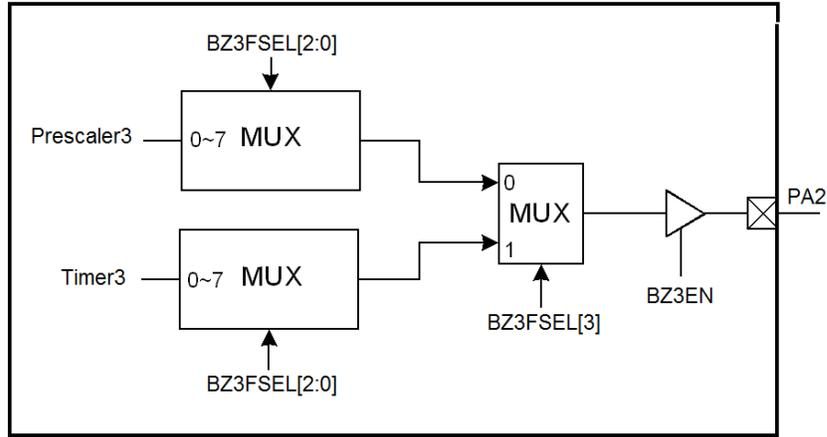
图 27 蜂鸣器 3 结构框图
