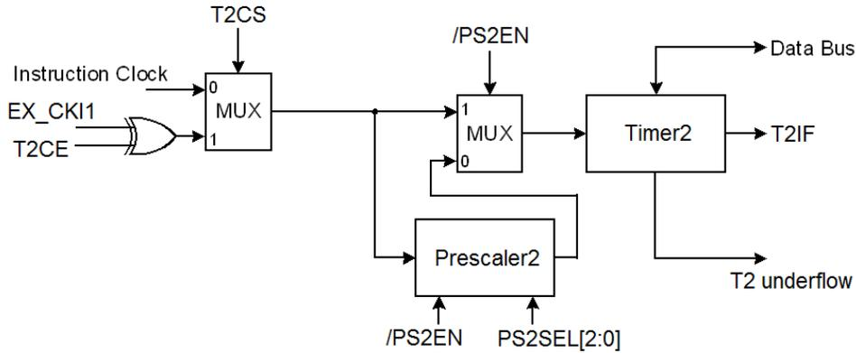
图 20 定时器 2 结构框图
