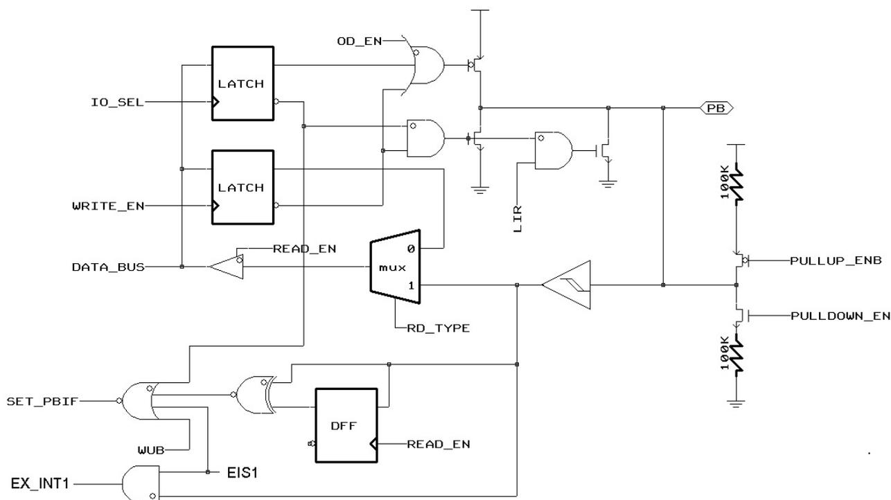
图 11 PB1 引脚结构框图
