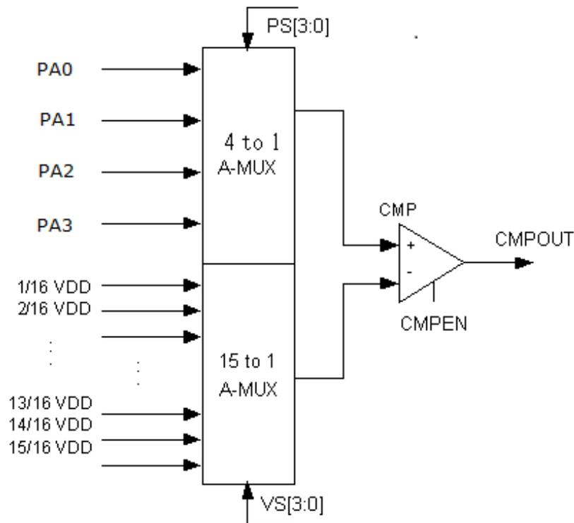
图 31 比较器P2V模式结构框图
