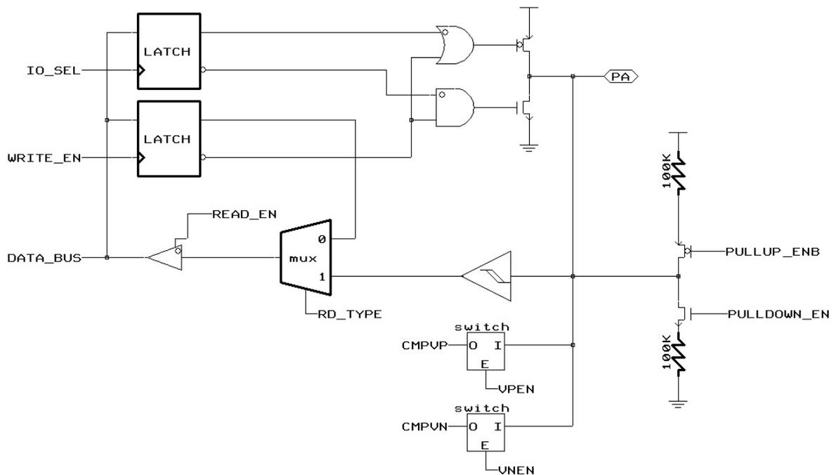
图 5 PA[3:2], PA0 引脚结构框图
