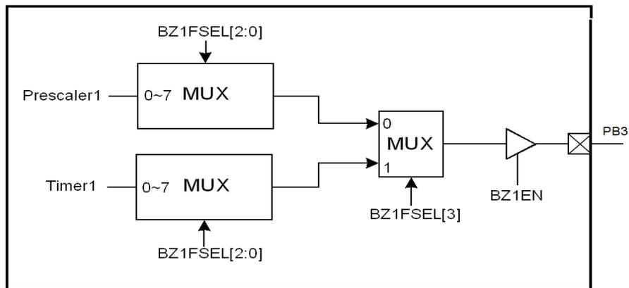
图 19 蜂鸣器 1 结构框图
