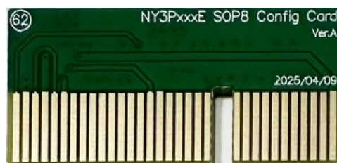
NY3PxxxE SOP8 转卡 (Config Card)
