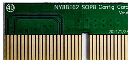
NY8BE62 SOP8 转卡 (Config Card)
