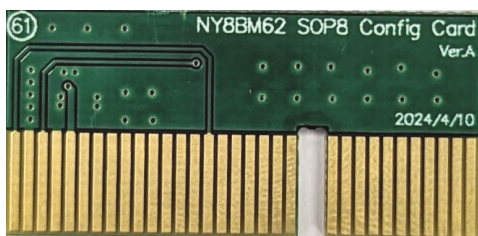
NY8BM62 SOP8 转卡 (Config Card)
