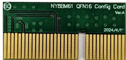
NY8BM61 QFN16 转卡 (Config Card)
