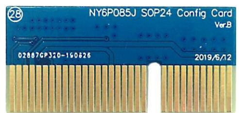
NY6P085J SOP24 转卡 (Config Card)
