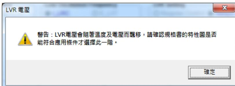
當溫度上升時，LVR 電壓也隨之降低，可能會使得 IC 最低可工作電壓高於 LVR 電壓，而使得 LVR 功能失效。預設的建議 LVR 電壓在 IC 工作溫度範圍內皆可運作正常，有關 LVR 電壓對溫度的關係圖請見 NY8A051F 規格書。若需選擇較低的 LVR 電壓，請確認規格書中的特性圖是否符合應用條件再進行選擇。
