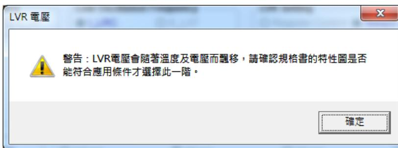
當溫度上升時，LVR 電壓也隨之降低，可能會使得 IC 最低可工作電壓高於 LVR 電壓，而使得 LVR 功能失效。預設的建議 LVR 電壓在 IC 工作溫度範圍內皆可運作正常，有關 LVR 電壓對溫度的關係圖請見 NY8BM61D/NY8BM62D 規格書。若需選擇較低的 LVR 電壓，請確認規格書中的特性圖是否符合應用條件再進行選擇。
