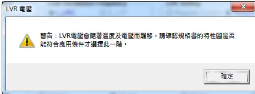
當溫度上升時，LVR 電壓也隨之降低，可能會使得 IC 最低可工作電壓高於 LVR 電壓，而使得 LVR 功能失效。預設的建議 LVR 電壓在 IC 工作溫度範圍內皆可運作正常，有關 LVR 電壓對溫度的關係圖請見 NY8A054E1 規格書。若需選擇較低的 LVR 電壓，請確認規格書中的特性圖是否符合應用條件再進行選擇。
