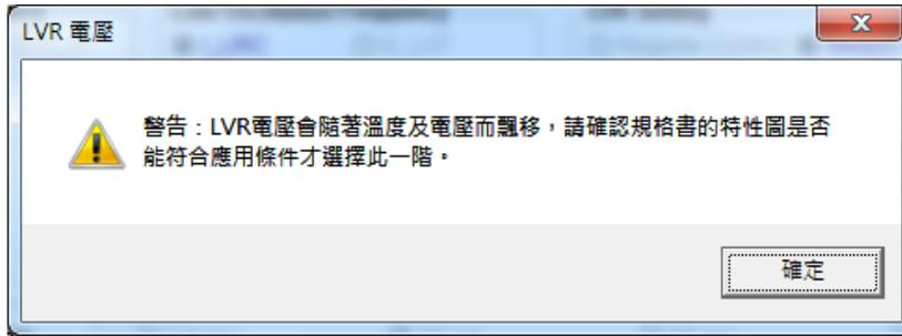
當溫度上升時，LVR 電壓也隨之降低，可能會使得 IC 最低可工作電壓高於 LVR 電壓，而使得 LVR 功能失效。預設的建議 LVR 電壓在 IC 工作溫度範圍內皆可運作正常，有關 LVR 電壓對溫度的關係圖請見 NY8A051L 規格書。若需選擇較低的 LVR 電壓，請確認規格書中的特性圖是否符合應用條件再進行選擇。
