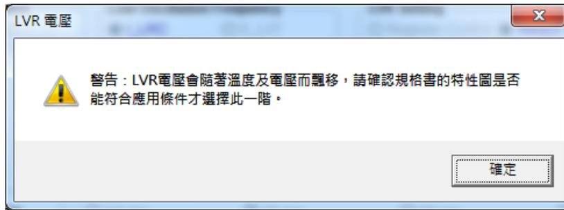
當溫度上升時，LVR 電壓也隨之降低，可能會使得 IC 最低可工作電壓高於 LVR 電壓，而使得 LVR 功能失效。預設的建議 LVR 電壓在 IC 工作溫度範圍內皆可運作正常，有關 LVR 電壓對溫度的關係圖請見 NY8A053B 規格書。若需選擇較低的 LVR 電壓，請確認規格書中的特性圖是否符合應用條件再進行選擇。
