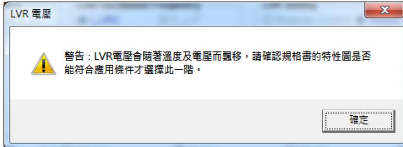
當溫度上升時，LVR 電壓也隨之降低，可能會使得 IC 最低可工作電壓高於 LVR 電壓，而使得 LVR 功能失效。預設的建議 LVR 電壓在 IC 工作溫度範圍內皆可運作正常，有關 LVR 電壓對溫度的關係圖請見 NY8B062B 規格書。若需選擇較低的 LVR 電壓，請確認規格書中的特性圖是否符合應用條件再進行選擇。
