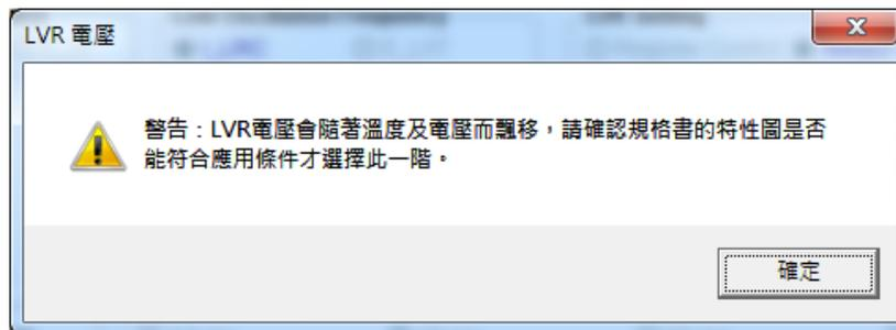
當溫度上升時，LVR 電壓也隨之降低，可能會使得 IC 最低可工作電壓高於 LVR 電壓，而使得 LVR 功能失效。預設的建議 LVR 電壓在 IC 工作溫度範圍內皆可運作正常，有關 LVR 電壓對溫度的關係圖請見 NY8A054E 規格書。若需選擇較低的 LVR 電壓，請確認規格書中的特性圖是否符合應用條件再進行選擇。
