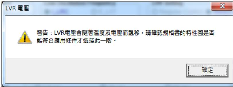
當溫度上升時，LVR 電壓也隨之降低，可能會使得 IC 最低可工作電壓高於 LVR 電壓，而使得 LVR 功能失效。預設的建議 LVR 電壓在 IC 工作溫度範圍內皆可運作正常，有關 LVR 電壓對溫度的關係圖請見 NY8A051K 規格書。若需選擇較低的 LVR 電壓，請確認規格書中的特性圖是否符合應用條件再進行選擇。
