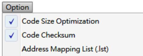
**Rom Size 最佳化 (Code Size Optimization)** : 最佳化 Rom Size。當勾選此選項時，*NY8 Code Converter* 在程式轉換時會盡量以一行指令轉一行的方式轉換，可達到轉換後 Rom Size 最小，但轉換後較容易出現功能異常。
