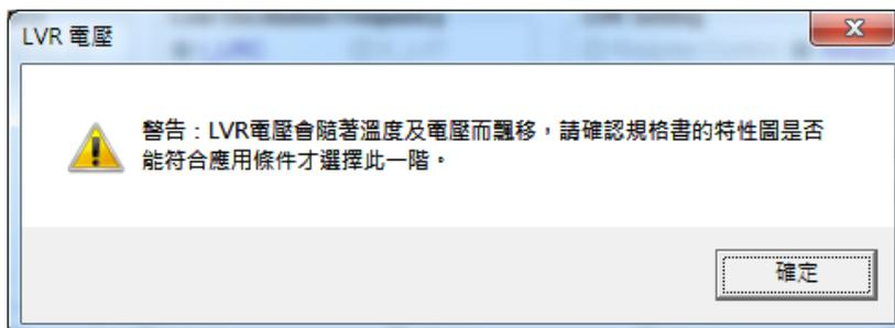
當溫度上升時，LVR 電壓也隨之降低，可能會使得 IC 最低可工作電壓高於 LVR 電壓，而使得 LVR 功能失效。預設的建議 LVR 電壓在 IC 工作溫度範圍內皆可運作正常，有關 LVR 電壓對溫度的關係圖請見 NY8A051J 規格書。若需選擇較低的 LVR 電壓，請確認規格書中的特性圖是否符合應用條件再進行選擇。
