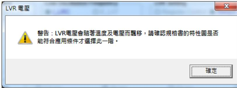
當溫度上升時，LVR 電壓也隨之降低，可能會使得 IC 最低可工作電壓高於 LVR 電壓，而使得 LVR 功能失效。預設的建議 LVR 電壓在 IC 工作溫度範圍內皆可運作正常，有關 LVR 電壓對溫度的關係圖請見 NY8B062F1 規格書。若需選擇較低的 LVR 電壓，請確認規格書中的特性圖是否符合應用條件再進行選擇。
