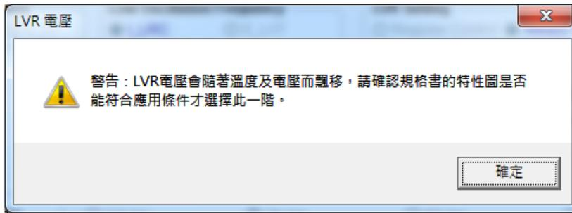
當溫度上升時，LVR 電壓也隨之降低，可能會使得 IC 最低可工作電壓高於 LVR 電壓，而使得 LVR 功能失效。預設的建議 LVR 電壓在 IC 工作溫度範圍內皆可運作正常，有關 LVR 電壓對溫度的關係圖請見 NY8A053E 規格書。若需選擇較低的 LVR 電壓，請確認規格書中的特性圖是否符合應用條件再進行選擇。
