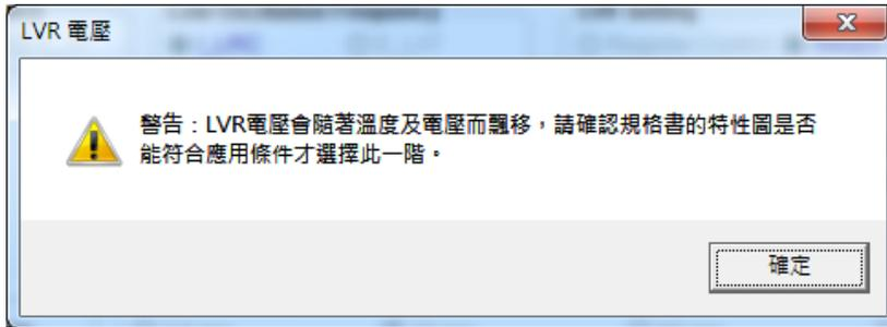
當溫度上升時，LVR 電壓也隨之降低，可能會使得 IC 最低可工作電壓高於 LVR 電壓，而使得 LVR 功能失效。預設的建議 LVR 電壓在 IC 工作溫度範圍內皆可運作正常，有關 LVR 電壓對溫度的關係圖請見 NY8B062A 規格書。若需選擇較低的 LVR 電壓，請確認規格書中的特性圖是否符合應用條件再進行選擇。
