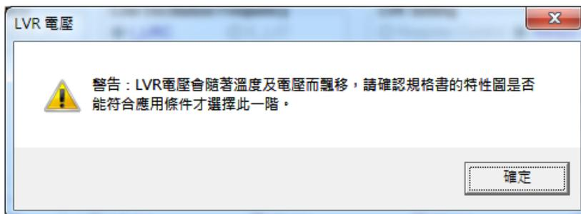
當溫度上升時，LVR 電壓也隨之降低，可能會使得 IC 最低可工作電壓高於 LVR 電壓，而使得 LVR 功能失效。預設的建議 LVR 電壓在 IC 工作溫度範圍內皆可運作正常，有關 LVR 電壓對溫度的關係圖請見
