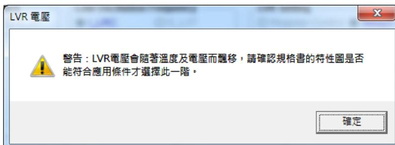
當溫度上升時，LVR 電壓也隨之降低，可能會使得 IC 最低可工作電壓高於 LVR 電壓，而使得 LVR 功能失效。預設的建議 LVR 電壓在 IC 工作溫度範圍內皆可運作正常，有關 LVR 電壓對溫度的關係圖請見 NY8A051H1 規格書。若需選擇較低的 LVR 電壓，請確認規格書中的特性圖是否符合應用條件再進行選擇。
