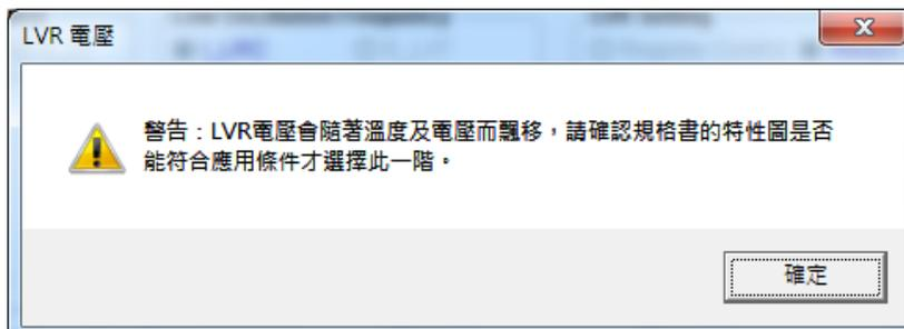
當溫度上升時，LVR 電壓也隨之降低，可能會使得 IC 最低可工作電壓高於 LVR 電壓，而使得 LVR 功能失效。預設的建議 LVR 電壓在 IC 工作溫度範圍內皆可運作正常，有關 LVR 電壓對溫度的關係圖請見 NY8A051G 規格書。若需選擇較低的 LVR 電壓，請確認規格書中的特性圖是否符合應用條件再進行選擇。
