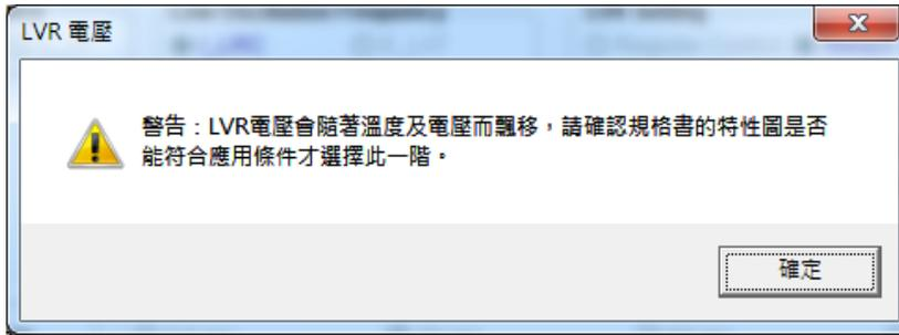
當溫度上升時，LVR 電壓也隨之降低，可能會使得 IC 最低可工作電壓高於 LVR 電壓，而使得 LVR 功能失效。預設的建議 LVR 電壓在 IC 工作溫度範圍內皆可運作正常，有關 LVR 電壓對溫度的關係圖請見 NY8B062F 規格書。若需選擇較低的 LVR 電壓，請確認規格書中的特性圖是否符合應用條件再進行選擇。
