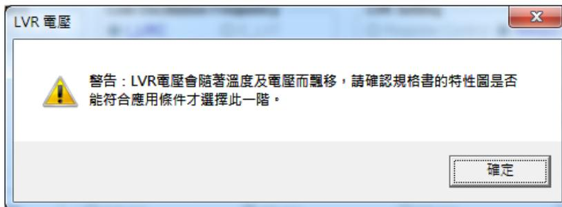
當溫度上升時，LVR 電壓也隨之降低，可能會使得 IC 最低可工作電壓高於 LVR 電壓，而使得 LVR 功能失效。預設的建議 LVR 電壓在 IC 工作溫度範圍內皆可運作正常，有關 LVR 電壓對溫度的關係圖請見 NY8A050E 規格書。若需選擇較低的 LVR 電壓，請確認規格書中的特性圖是否符合應用條件再進行選擇。
