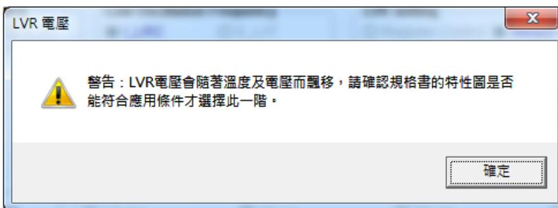
當溫度上升時，LVR 電壓也隨之降低，可能會使得 IC 最低可工作電壓高於 LVR 電壓，而使得 LVR 功能失效。預設的建議 LVR 電壓在 IC 工作溫度範圍內皆可運作正常，有關 LVR 電壓對溫度的關係圖請見 NY8A051B 規格書。若需選擇較低的 LVR 電壓，請確認規格書中的特性圖是否符合應用條件再進行選擇。
