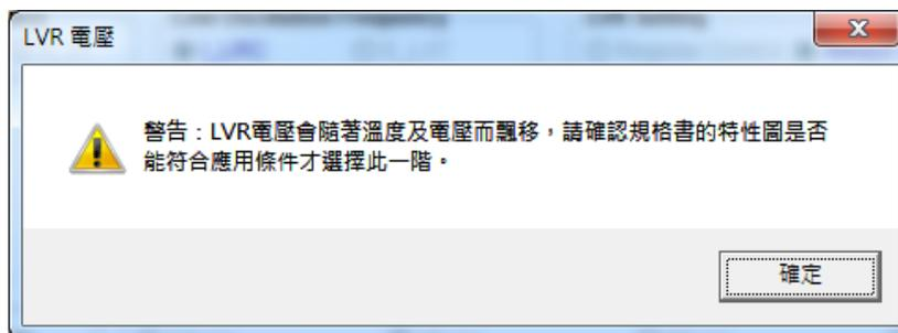
當溫度上升時，LVR 電壓也隨之降低，可能會使得 IC 最低可工作電壓高於 LVR 電壓，而使得 LVR 功能失效。預設的建議 LVR 電壓在 IC 工作溫度範圍內皆可運作正常，有關 LVR 電壓對溫度的關係圖請見 NY8B061E 規格書。若需選擇較低的 LVR 電壓，請確認規格書中的特性圖是否符合應用條件再進行選擇。
