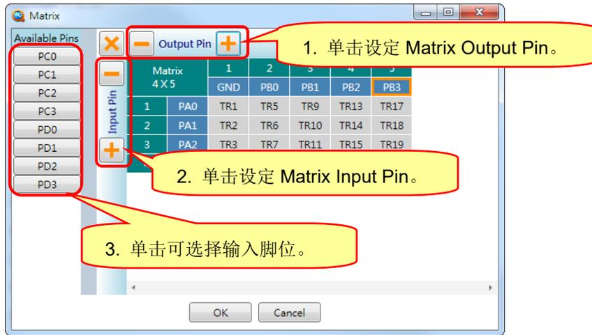
例. Matrix = [ PA.0, PA.1 ] \* [ GND, PB.0, PA.2 ] ; 使用 GND 来做 Matrix 按键扫描。
